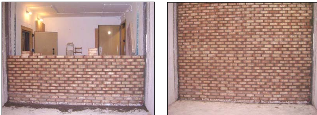
Fotografías 2 y 3 Construcción de la pared en el marco portamuestras
